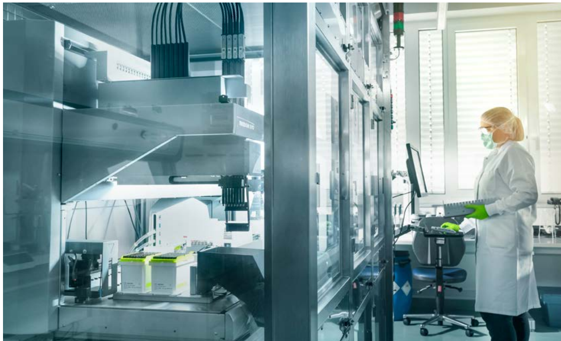
Vorbereitung eines Roboters zur automatisierten Befüllung (automatic liquid handling)
